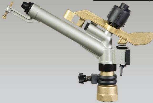
Irrigatore di media portata a funzionamento circolare o a settori. È dotato di ugelli intercambiabili e di un rompigelletto a penetrazione regolabile, che assicura una precipitazione fine e uniformemente distribuita. Tra le sue caratteristiche spiccano in particolare la grande semplicità dei meccanismi e la straordinaria versatilità d'impiego. È adatto per qualsiasi tipo di impianto e si presta per terreni di qualsiasi natura ed estensione.
